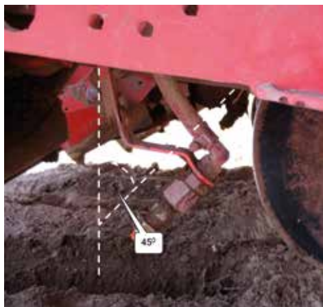
Правильна установка розпилювача — 45–55 градусів від вертикалі
