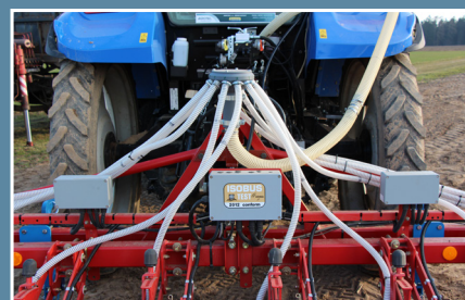
установка розподільчої головки і шлангів для мікрогранул до кожної секції
