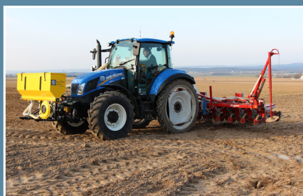
установка на передній частині трактора та під'єднання до сівалки точного висіву для цукрових буряків
