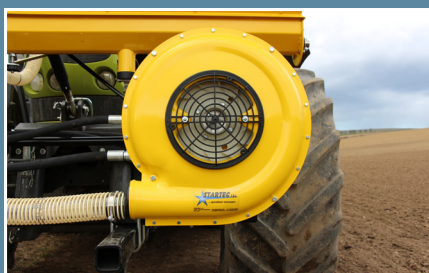
Вентилятор, який під'єднується до гідравлічного контура трактора
